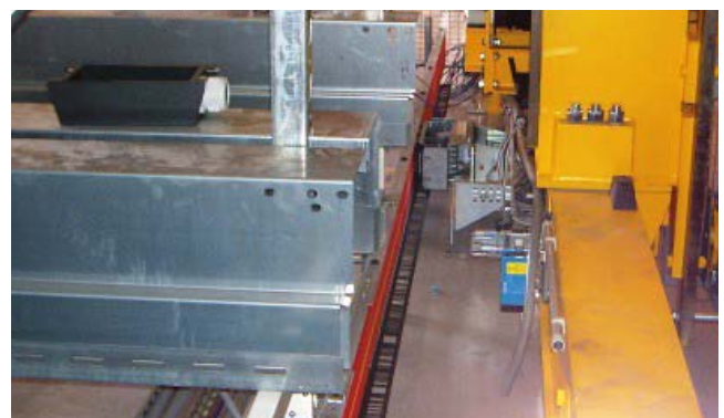
Toepassing van een 10-polig Pro-Ductorsysteem met codeerband
