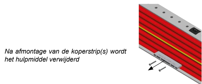
Isolatiestrip waarop koperstrip wordt aangebracht m.b.v. PR-ISO montagehulpmiddel
