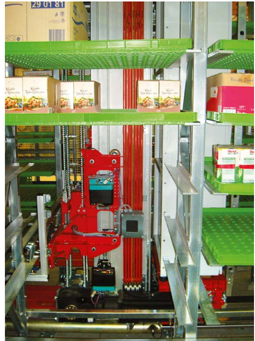
Toepassing van Mast-stroomrail (7-polig Pro-Ductorsysteem) op mini-load
